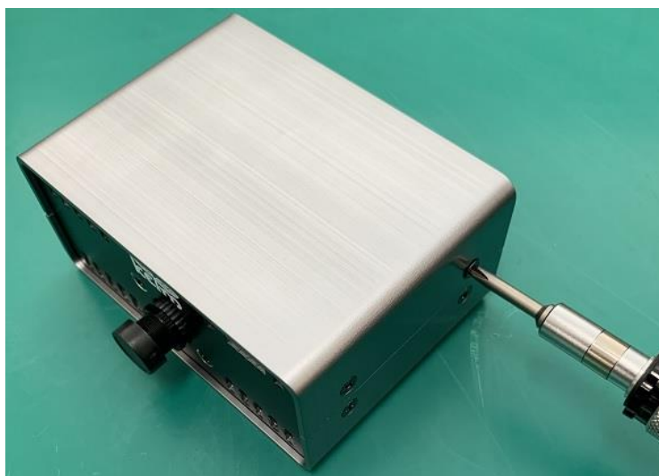
図 3-4 筐体のネジ止め
